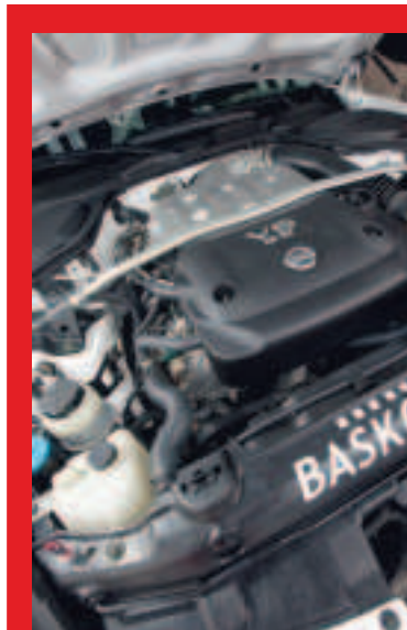
Met vijftig procent bio-methanol is het vermogen van de zescilinder gelijk aan dat van de gewone benzineversie.
