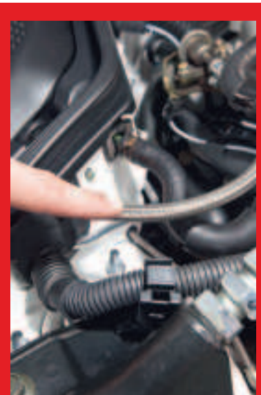
Het injectiesysteem en de brandstofleidingen moesten aangepast worden aan de andere brandstof.
