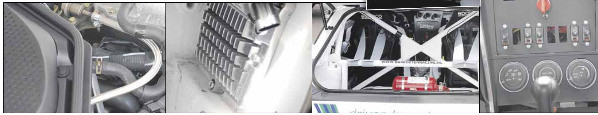
De fysieke wijzigingen aan motor en brandstofsysteem in de motorruimte zijn minimaal. De aanpassing van het motormanagement geschiedt door middel van een aan het schutbord in de voetenruimte van de passagier gemonteerde 'piggyback' (tweede van links).
